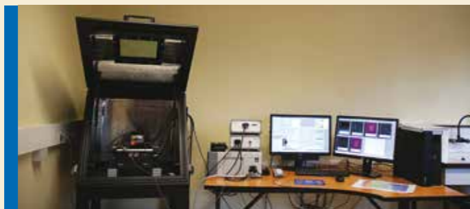
Microscope à sonde locale utilisée par l'Unité de Catalyse et de Chimie du Solide pour les recherches sur les nanomatériaux.
